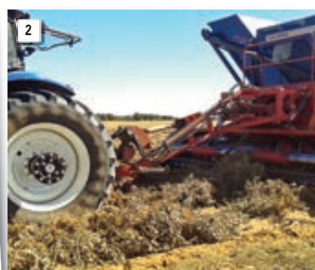
◀ 1: 'n Grondboonuithaler besig om grondbone te lig en in windrye te gooi. ▶ 2: 'n Meganiese grondboonplukker.
